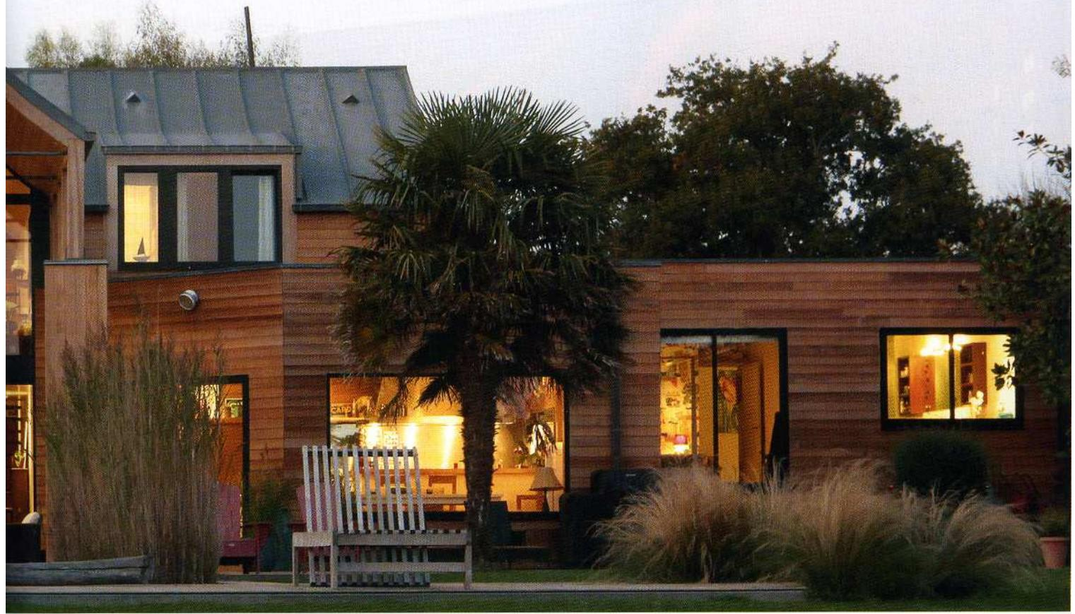
Les lames du bardage ont été lasurées (produit WoodGuard® Pro) pour retarder le vieillissement du bois, assurer une protection aux UV et faciliter l'entretien. La lasure va ainsi permettre de conserver l'aspect neuf et propre du bois beaucoup plus longtemps.
